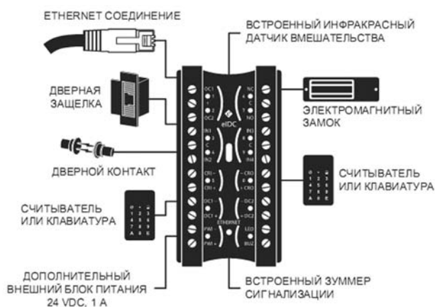
Схема подключения устройств к контроллеру INTELLI-M eIDC
