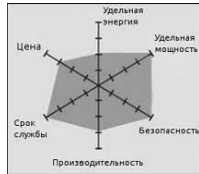
Малюнок №13. Діаграма основних властивостей акумуляторів LiFePO 4 .
